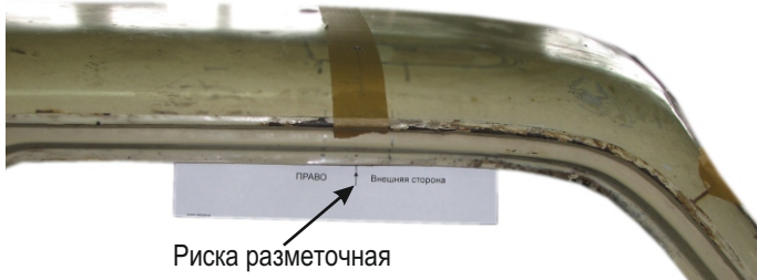
Рис.3 Установка шаблонов. Вид изнутри автомобиля
